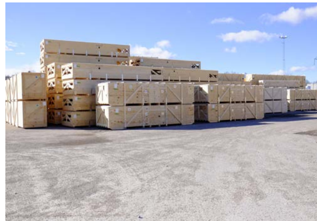
Det är viktigt att anpassa förpackningarna så att de klarar stapeltrycket.
