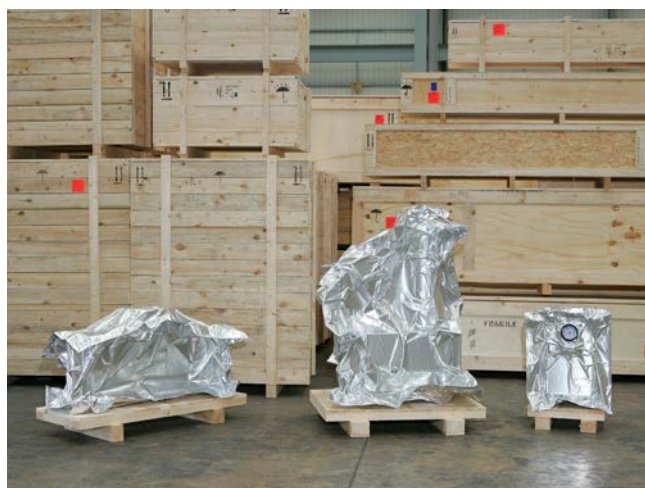
Barriärmaterial förekommer även vid transport på pall, med och utan luftfuktighetsindikator.
