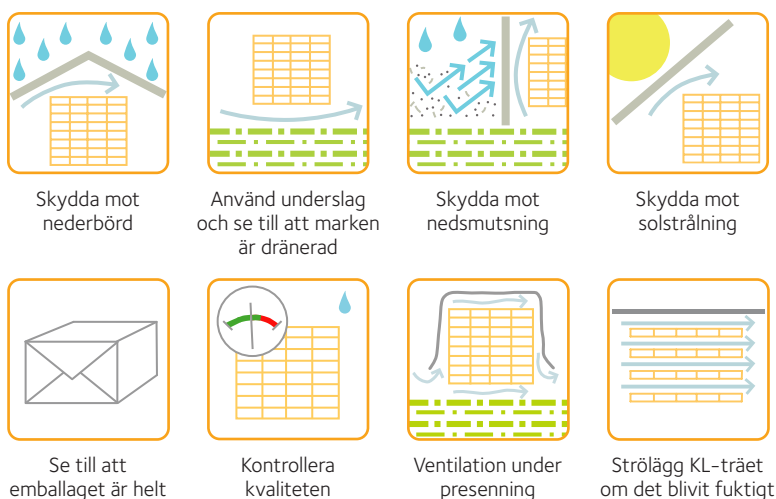
Figur 4 Några viktiga principer för att skydda KL-träprodukter
