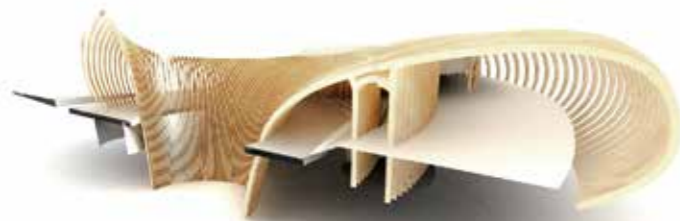
Museets limträkonstruktion med sina böjande bågar är inspirerad av fartygsanatomi, vilket ger en tydlig länk mellan land och vatten.
