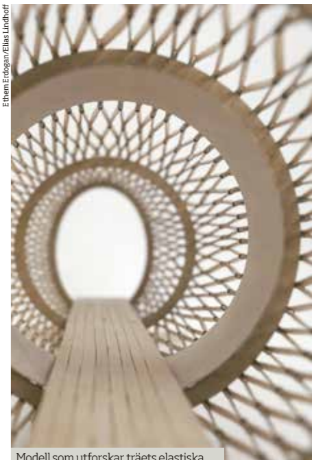
Modell som utforskar träets elastiska egenskaper med en tunnel konstruerad av hyvlade, utsträckta träribbor.
