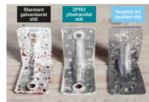
Bild: Resultat av cykliskt test Normal utomhusmiljö - Tid: ca 1400h (C3=1200-1300h = ca: 15 år)
