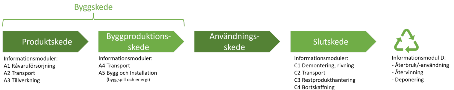
Figur 5. Livscykelanalys (LCA) - Skedesindelning och informationsmoduler
