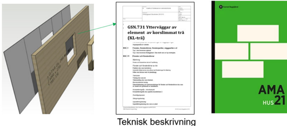
Figur 60. Ritning och modell kompletteras av en Teknisk Beskrivning baserad på AMA Hus med krav på utförande.
