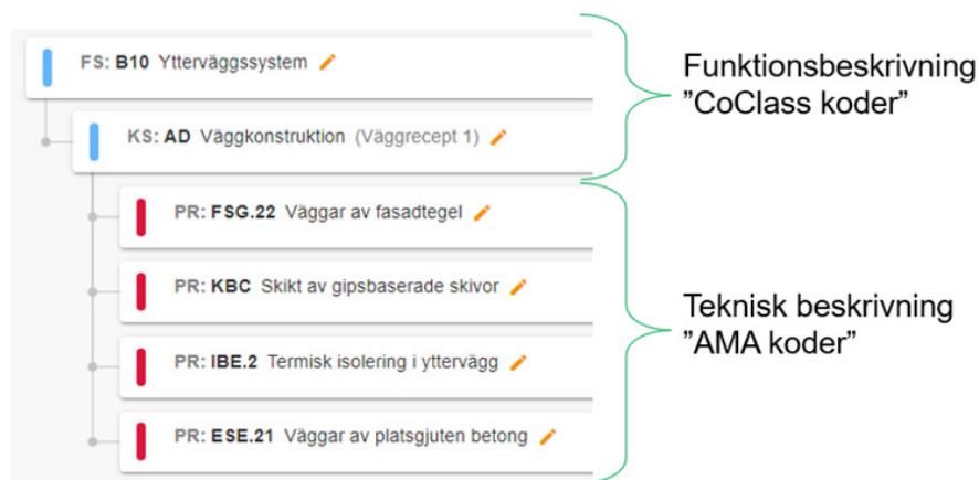
Figur 58. Nedbrytning av ett Ytterväggssystem i dess ingående Produktionsresultat (arbeten). I princip ett ”kalkylrecept” för att kalkylera kostnad och klimatpåverkan.
