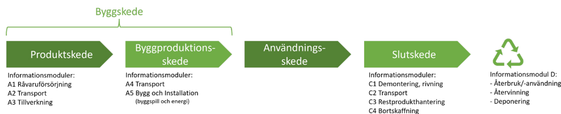
Figur 5. Livscykelanalys (LCA) - Skedesindelning och informationsmoduler
