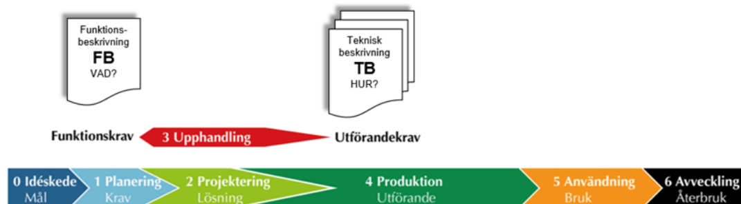
Figur 54. Skedesindelning av bygg- och förvaltningsprocessen med olika typer av kravbeskrivningar
