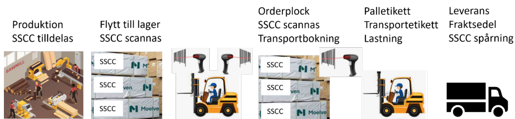
Figur 53. SSCC vid produktion, förflyttning och leverans.
